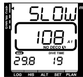
図20 浮上スピードメーター 4つめのポジション： 浮上速度は11m/分以上。浮上速度 10m/分を連続的に越えた為に SLOWが表示。スピードを落とさ なければなりません。
