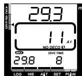
図17 無減圧限度バーグラフ 無減圧時間が60分以下に減少すると1つめのバーが左から表示される。無減圧時間が40分、30分、20分以下（グリーンゾーン）、10分以下（イエローゾーン）に減少すると次々にバーが表れる。
