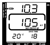
図19 浮上スピードメーター 3つめのポジション： 浮上速度は9~11m/分
