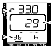
図31 ダイブヒストリー 今までに到達した最大深度は 33.0m (a)、合計潜水時間は29時間 間 (c)。合計潜水回数は36回 (b)。
