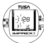
図38 時計設定 コンタクト①と③で時間を調整します。
