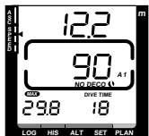
図18 浮上スピードメーター 2つめのポジション： 浮上速度は7~9m/分
