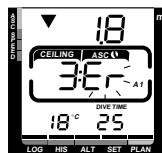
図23 シーリングより浅い深度での減圧潜水 下向き矢印が表示され、E警告が点滅。3分以内に直ちにシーリング又はシーリングより深い深度へ移動しなければならない。
