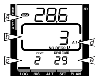
図28 ログブックディスプレイI ディスプレイII、IIIと交互に表示。 ログナンバー2 (c) の最大深度は 28.6m (a)、潜水時間は29分 (e)。 高度個人調整モードではA1 (d) で、最短無減圧時間は3分。(b)
