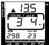
図21 シーリングの下での減圧潜水 最短浮上時間は4分。上向き矢印が浮上指示を表している。シーリングは3m。
